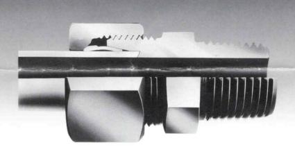
くい込み継手に関するトップメーカーとしての長年にわたり蓄積された技術と経験にもとずいて、銅管用に設計されたのがB形です。ナットの締付けによりスリーブ先端のカッティングエッジが管にくい込み、中央部が湾曲し、圧縮され、その強力なバネ作用により振動によるナットの緩みを防ぐ構造になっています。
